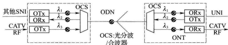
图 9.1.4 单纤三波长 FTTH 结构图
